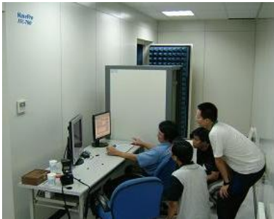
天線遠場量測系統_NSI 800F-10
